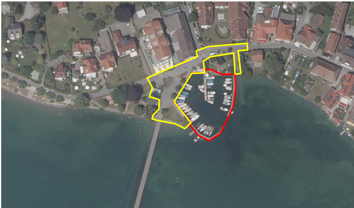
Abbildung 2: Mögliche Flächen für die Baustelleneinrichtung, gelb = Flächen an Land, rot = Hafenbecken (Grundlage Orthofoto: LUBW)
